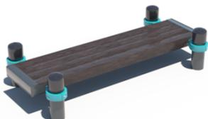
Комплекс состоит из четырех опорных столбов высотой 400 мм и горизонтальной скамьи. ДПК брус скамьи крепится к опорным столбам при помощи хомутов и перекладин длиной 500 мм на высоте 275 мм от поверхности основания. Длина рабочей поверхности скамьи составляет 1500 мм, ширина - 400 мм, высота скамьи 325 мм. Длина комплекса не более 1500 мм.
