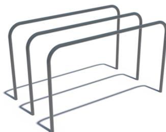
Комплекс состоит из трех жердей. Жерди брусьев расположены параллельно. Расстояние между внутренними поверхностями жердей 500 мм, рабочая поверхность - 1800 мм. Жерди брусьев симметрично изогнуты под углом 90 градусов, высота - 1200 мм от поверхности основания. Длина комплекса не более 2100 мм.
