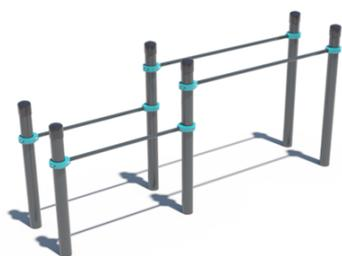
Комплекс состоит из шести опорных столбов высотой: 2 шт. - 1200 мм, 4 шт. - 1500 мм и четырех жердей, представляющих собой горизонтальные перекладины длиной: 2 шт. - 1758 мм, 2 шт. - 1200 мм., которые фиксируются при помощи хомутов на высоте 1300 мм и 900 мм от поверхности основания, соответственно. Расстояние между центрами опорных столбов брусьев 600 мм. Длина комплекса не более 3300 мм.
